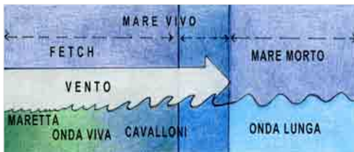
Figura 4: il fetch e la trasformazione delle onde.
