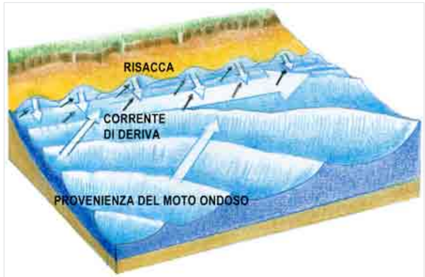
Figura 3: formazione di corrente litorale lungo la riva.
