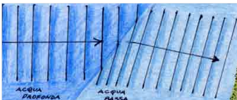
Figura 4: schema di rifrazione delle onde.
